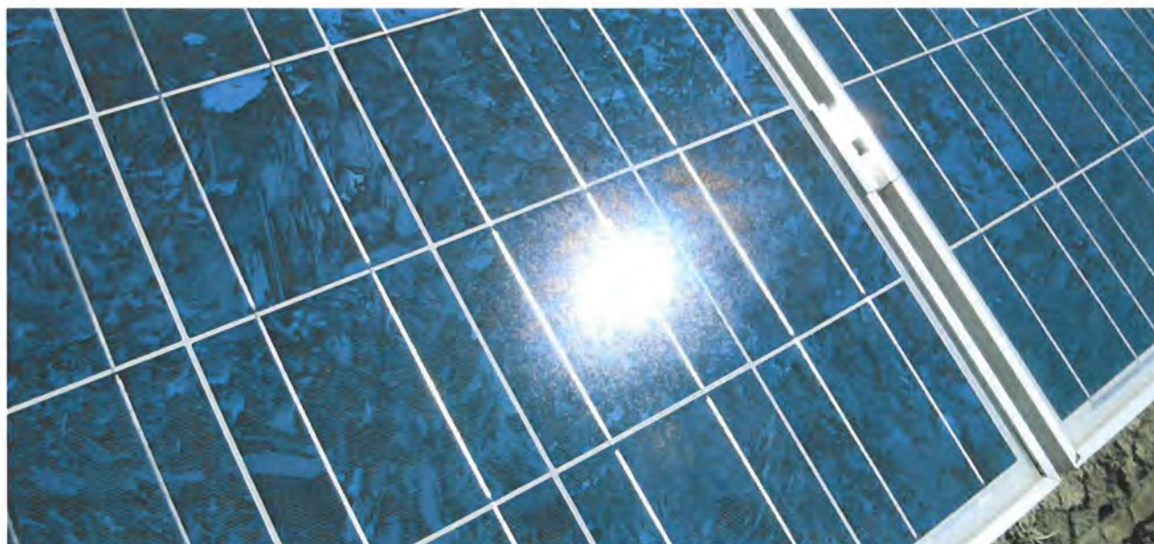
Bild 3.2.2: Diffuse Reflexion von direkten Sonnenlicht (Einstrahlung ca. 980 W/m 2 ) auf einem PV Modul (Quelle: SolPEG)
