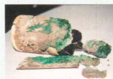
Bohrkern eines Hallenbodens mit grünen Chromverunreinigungen
